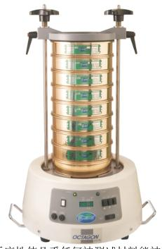
OCTAGON D200 高效数显筛分仪提供全面适应性使几乎任何被测试材料能被建立最佳的设置。筛分仪装备了新的完全独特的固定装置,确保筛网能被牢固的固定又不会过紧,使其能被快速的移除和重置。筛分仪安装了非金属弹簧和抗震装置用于隔离工作面的振动并降低噪音。
